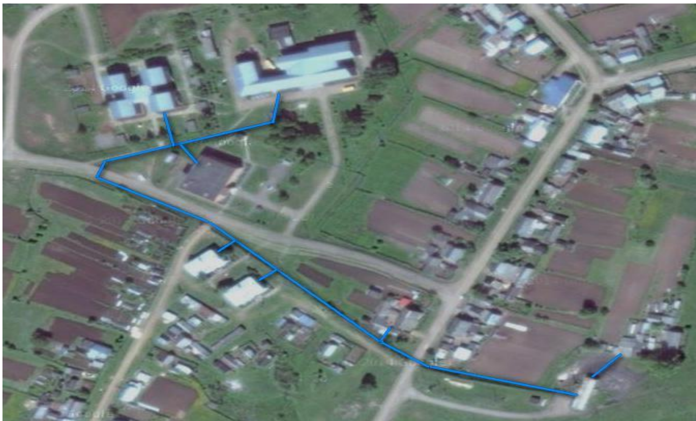
Рис 12 Схема тепловой сети в зоне действия котельной № 1 подлежащая реконструкции
